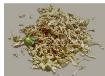
High Mw PTAA fibers
